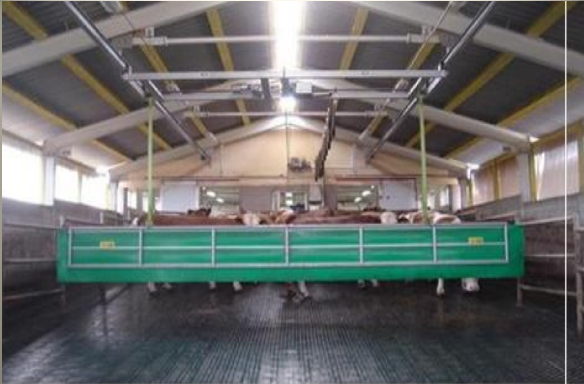
Рис. Електромеханічний автопідганяльник корів
