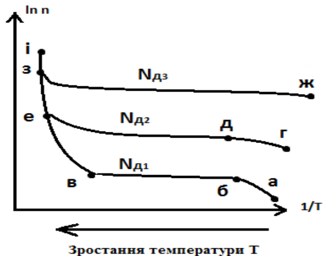
Рисунок 7.3 – Типові залежності концентрації носіїв заряду у напівпровіднику від температури при різній концентрації донорних домішок ( N_{d1} < N_{d2} < N_{d3} )
