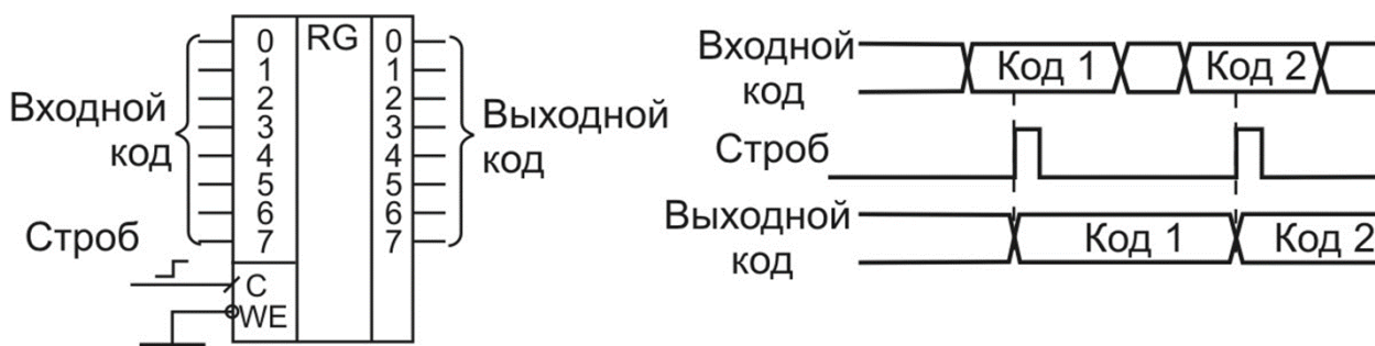
Рисунок 3 – Типи паралельних регістрів: реєстри, що тактуються та регістр-засувка
