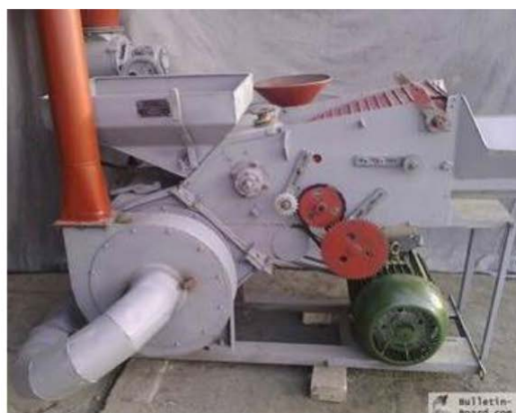
Рис. 8.1. Конструктивно-функціональна схема (а) і загальний вигляд дробарки КДУ-2:
