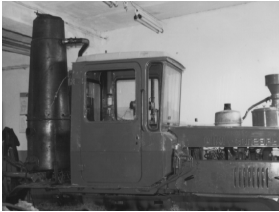
Рис. 3. - Встановлення газогенераторної установки на трактор ДТ-175С.
