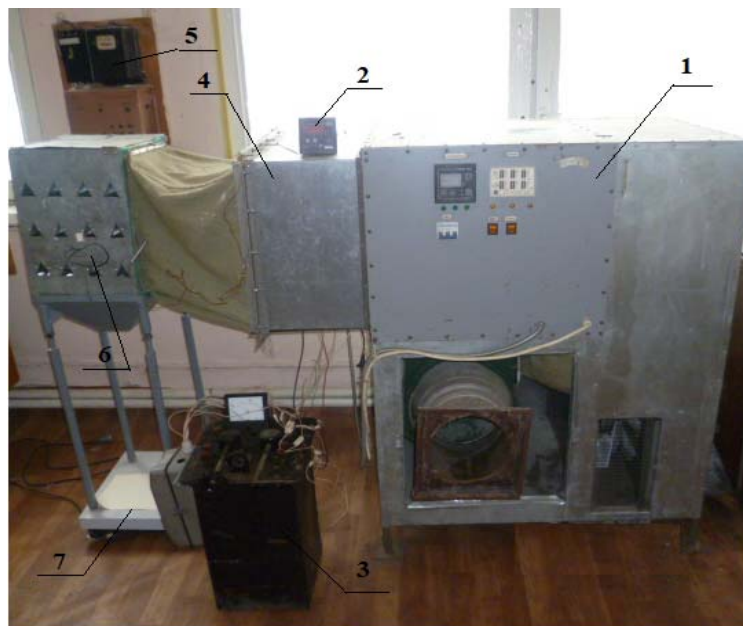
Рис. 1. Експериментальна конвективно-теплонасосна зерносушарка: 1 – теплонасосний агрегат з щитом керування; 2 – терморегулятор; 3 – автотрансформатор; 4 – блок нагрівачів; 5 – лічильник електроенергії; 6 – сушильна шахта; 7 – терези
