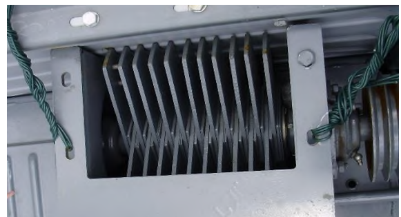
Рис. 4. Вигляд молоткового робочого органу комбайна Дон 680М
