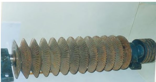
Рис. 3. Вигляд вальця набраного з рифлених конічних дисків
