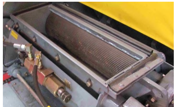
Рис. 2. Вигляд рифлених циліндричних вальців Палессе FS80-2
