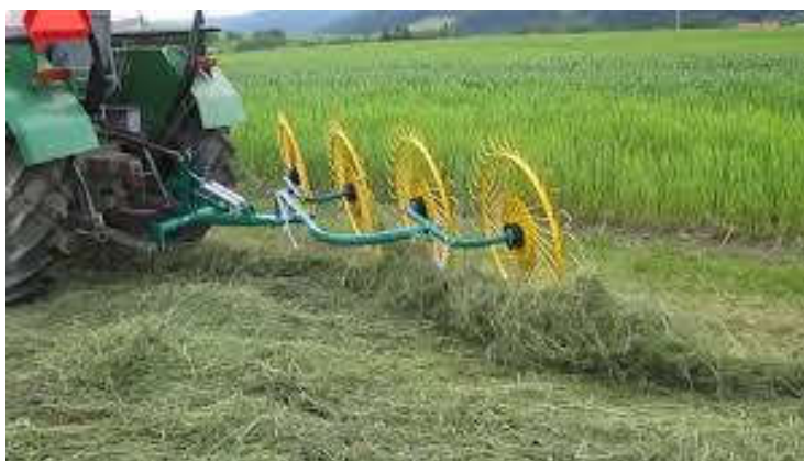
Рисунок 3. Начіпні колісно пальцеві граблі в роботі.
