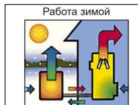
Зимой GHP система тепло неустойчивой земли передает в дом. Этот же цикл используется и при нагреве воды.
