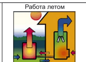
Летом GHP система излишки тепла в доме передает через теплообменник в обратном направлении.
