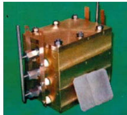
Рис. 1. Блочный микрореактор паровой конверсии метанола размером 65×90×85 мм, изготовленный из латуни
