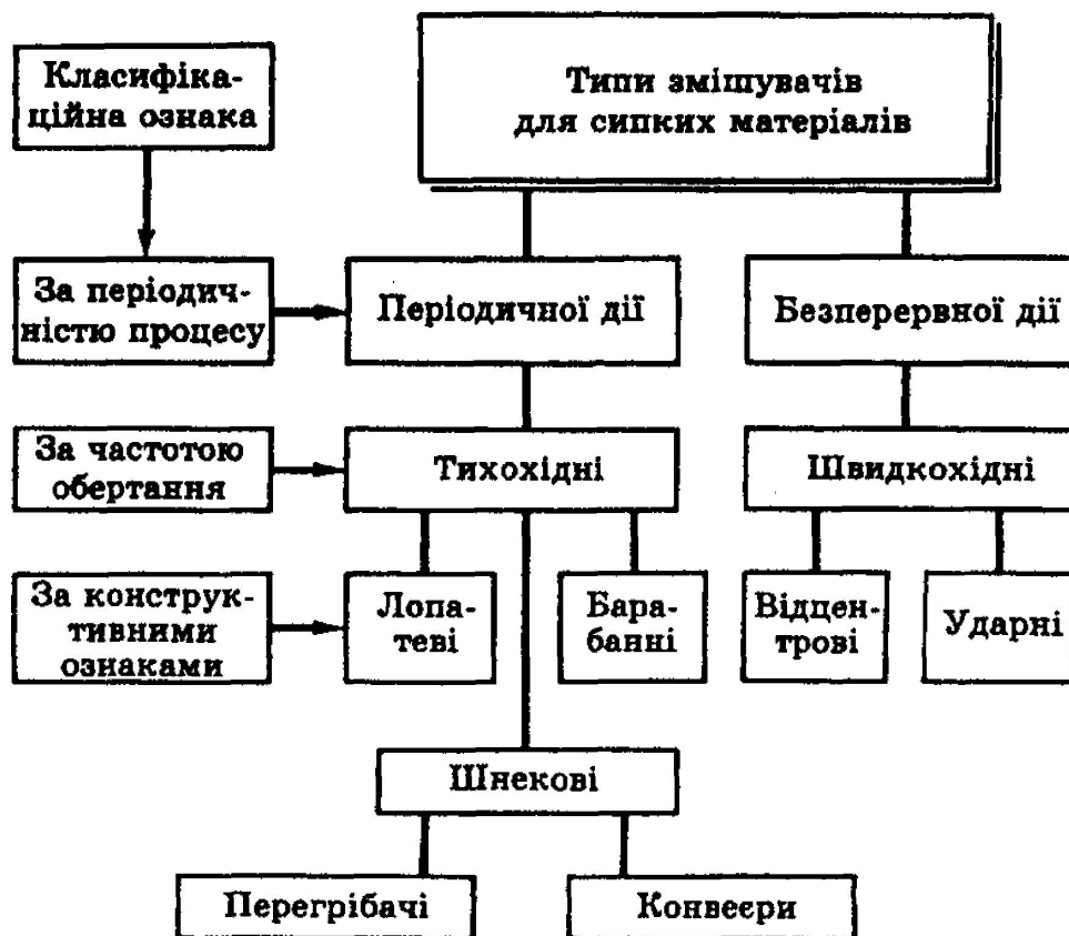
Рисунок 2.9 – Класифікація змішувачів для перероблення сипких матеріалів
