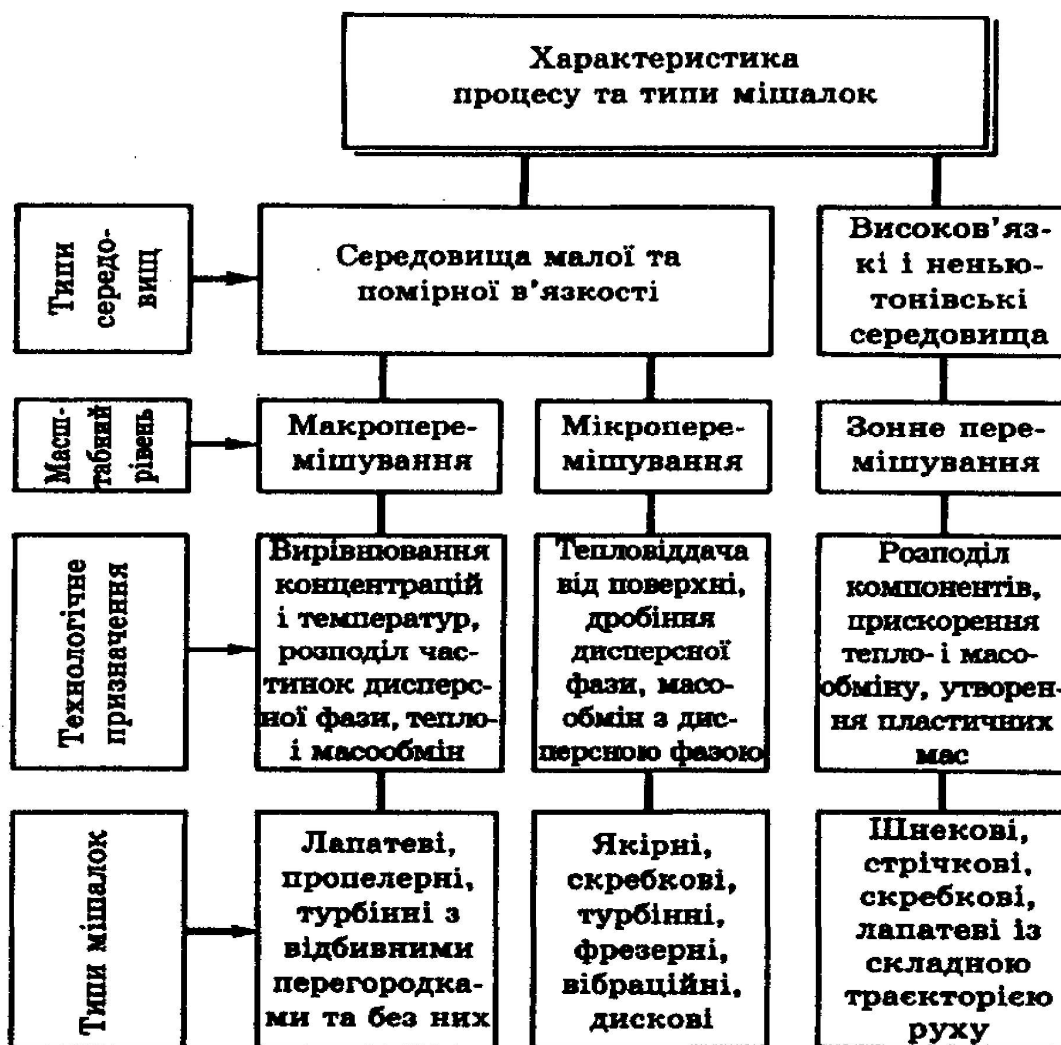
Рисунок 2.1 – Класифікація механічних мішалок за видом середовища, що перемішується, масштабним рівнем процесу та технологічним призначенням
