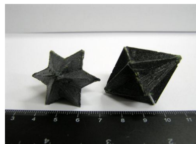
Рис. 1. Абразивные гранулы П12: а – эскиз; б – внешний вид; \alpha – внутренний угол невыпуклого шестиугольника, образующего основание абразивной гранулы; \beta – внешний угол невыпуклого шестиугольника, образующего основание абразивной гранулы; \gamma – угол при вершине абразивной гранулы; d – диаметр окружности, описывающей основание абразивной гранулы; l – длина образующей абразивной гранулы; b – длина рабочей поверхности в основании гранулы; h – высота гранулы
