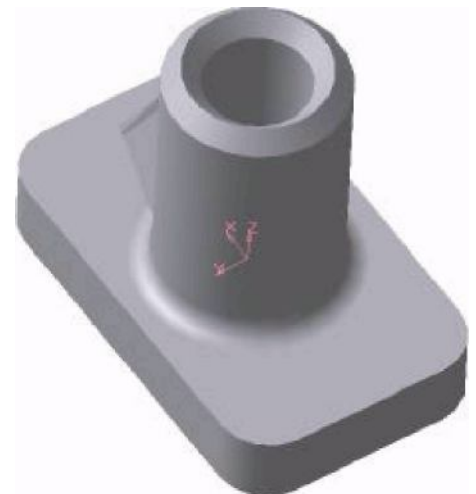
Рис. 7.3. Модель із виконаними округленнями
