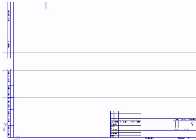
Рис. 1.16. Допоміжні прямі, що задають положення основних видів на робочому полі креслення
