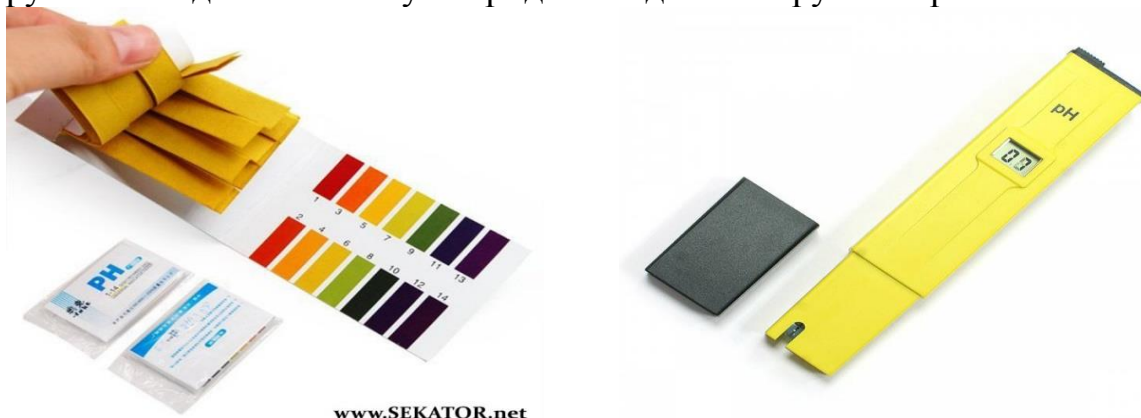
Рис 10. а- лакмусові тест-смужки; б- рН-метр PH-009.
