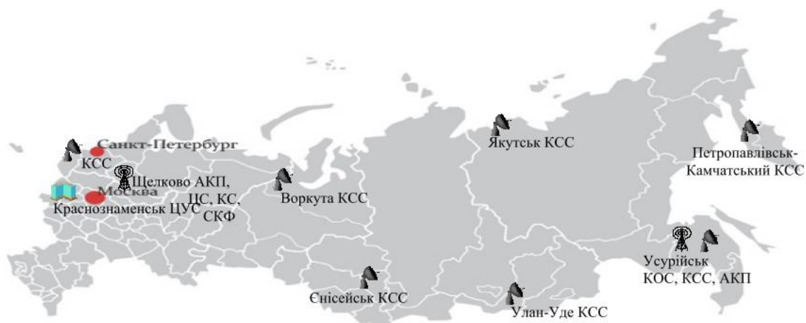
Рис. 4. Розміщення станцій контролю й управління системи GLONASS:
