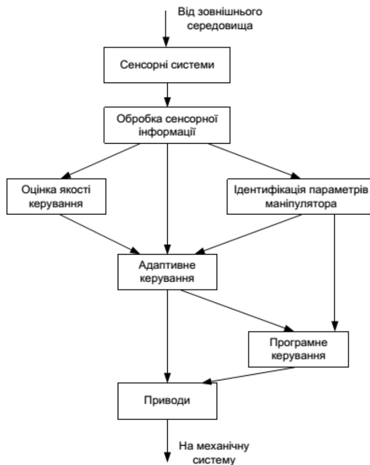
Рис. 15.3. Схема адаптивного керування маніпулятором
