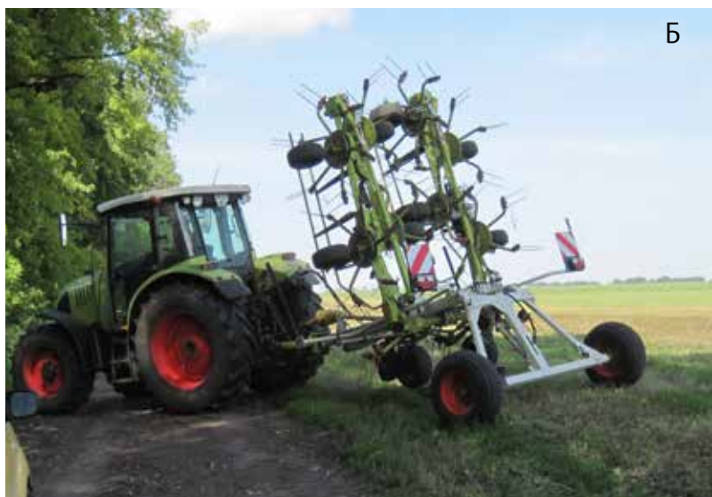
Фото 1. Причіпна ворушилка трави в роботі; а — під час переїзду в складеному стані, б — під час ворущіння, вид збоку
