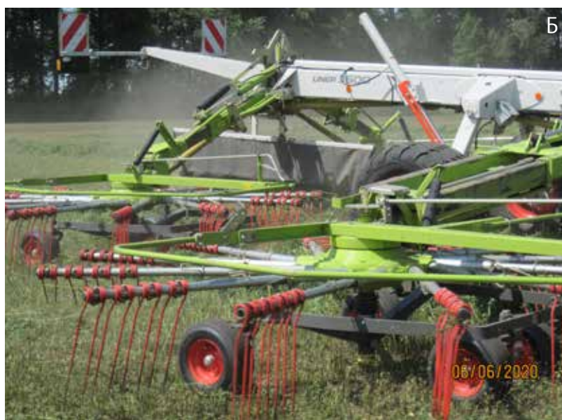
Фото 2. Граблі чотирироторні в роботі (а), ротор граблів (б)
