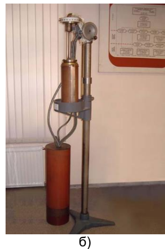
Рис. 2. Лабораторна установка для визначення теплофізичних властивостей матеріалу: а – схема, б – загальний вигляд
