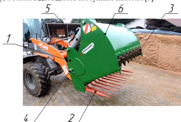
Рис.6. Вирізаючий механізм «алігаторного» – відкусуючого типу: 1-рама, 2-вила, 3-ніж, 4-вісь, 5-гідроциліндр, 6-П – підбірна рамка
