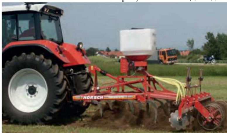
Рисунок 2.51 – Висівний модуль TECHNIK-PLUS TURBO-JET SUPER на ґрунтообробн.ому агрегаті HORSCH 948 .
