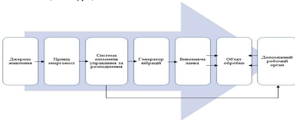
Рис. 1.– Структурна схема типової ВМ та ВУМ.
