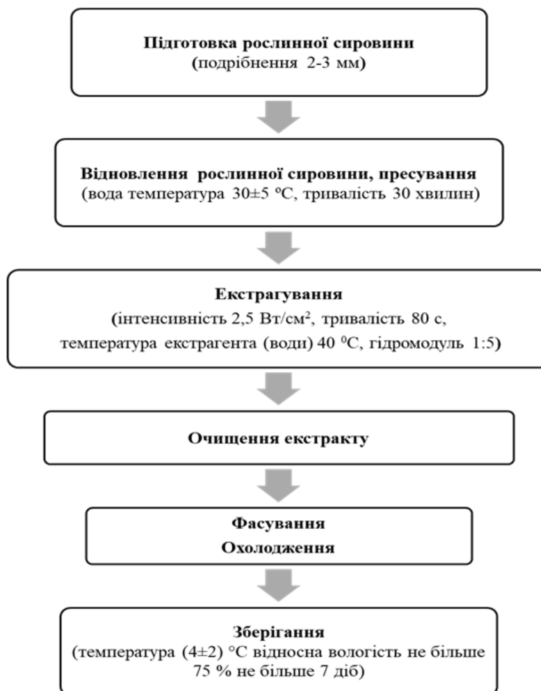
Рис. 2. Технологічна схема отримання екстракту з рослинної сировини за використання ультразвукової кавітаційної технології
