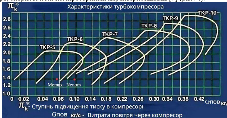
Рис. 4. Співставлення розрахункових характерних точок витрати повітря двигуна 4ЧН11,0/13,0 на режимі N_e = N_{enom} та M_e = M_{emax} з компресорними характеристиками турбокомпресорів, що використовуються на тракторних двигунах.
