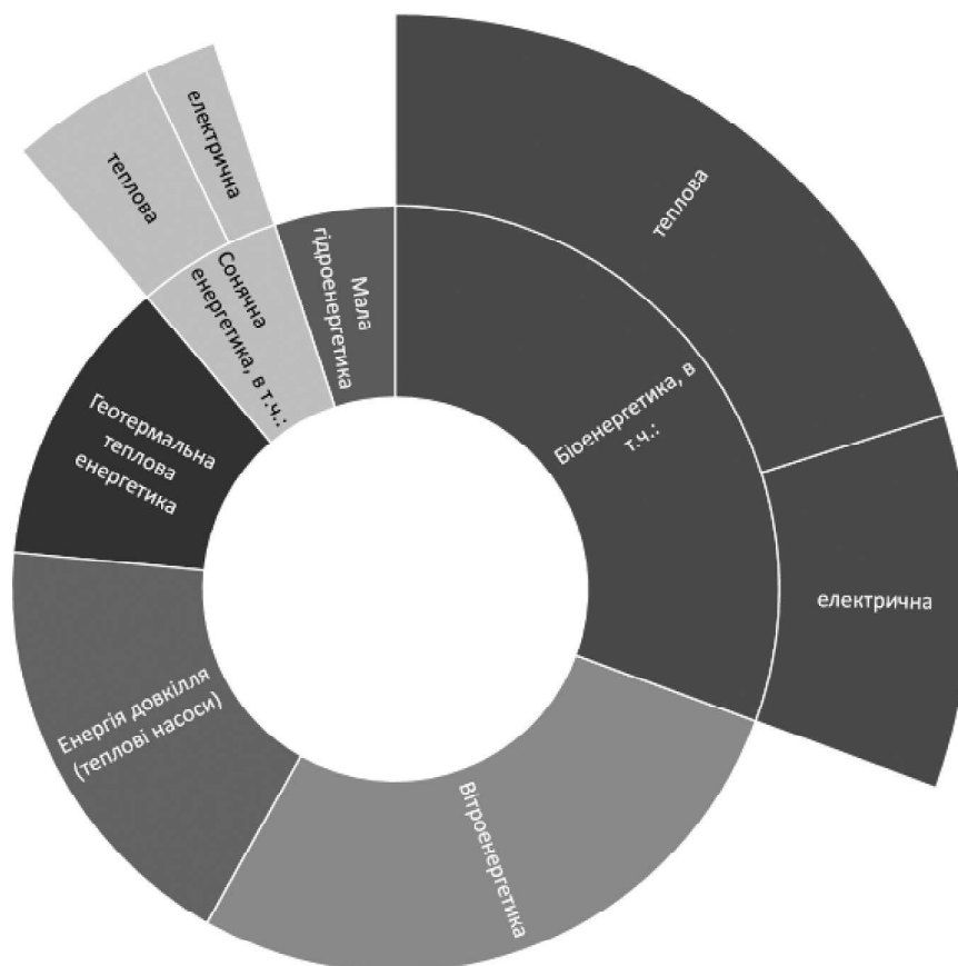
Рис. 2. Структура технічно-досяжного потенціалу вироблення енергоносіїв з відновлюваних джерел енергії та альтернативних видів палива
