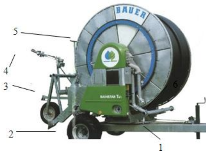
1 - шасі; 2 - пневматичні колеса; 3 - рама візка; 4 - дощувальний апарат; 5 - катушка з гнучким трубопроводом; 6 - вузол під'єднання.
