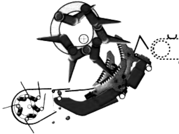
Рис. 4. - Схема подрібнювального пристрою з керованими граблинами візків-підбирачів Boss junior і Euroboss
