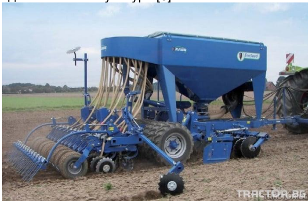
Рис. 3. Комбінований ґрунтообробний-посівний агрегат EcoSeed фірми Rabe для посіву по мульчі.
