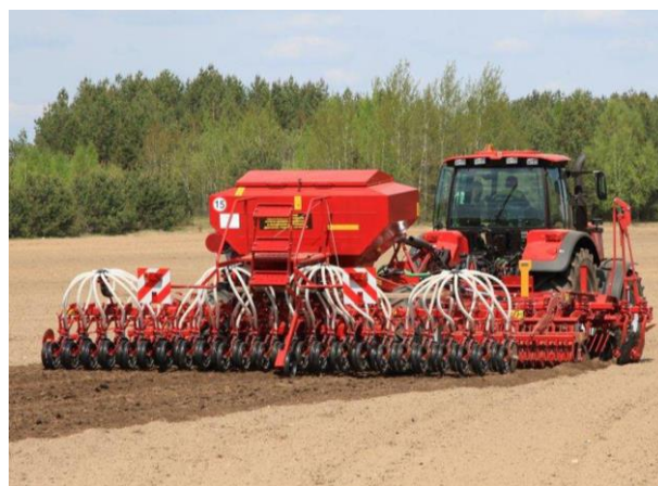
Рис. 8. Агрегат ґрунтообробно-посівний багатofункціональний АППМ-6 з дисковими робочими органами
