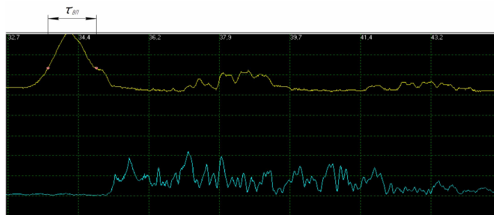
Рис. 2. Визначення тривалості впорскування дизельного палива при частоті n = 2200 об/хв на режимі холостого ходу
