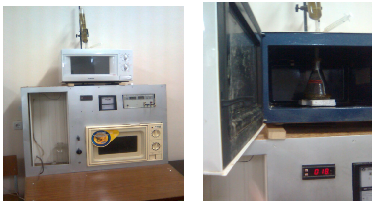
Рис. 1. Експериментальна установка екстрактора МХ для екстрагування олій
